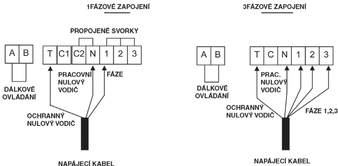
Všechny el. ohřevy řady RTI-EZ lze napájet jednofázovým i třífázovým napětím.
