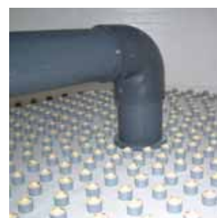
Falešné dno se vzduchovými tryskami
