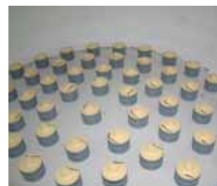
Detail falešného dna se vzduchovými tryskami
