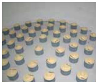
Detail falešného dna se vzduchovými tryskami
