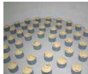
Detail falešného dna se vzduchovými tryskami
